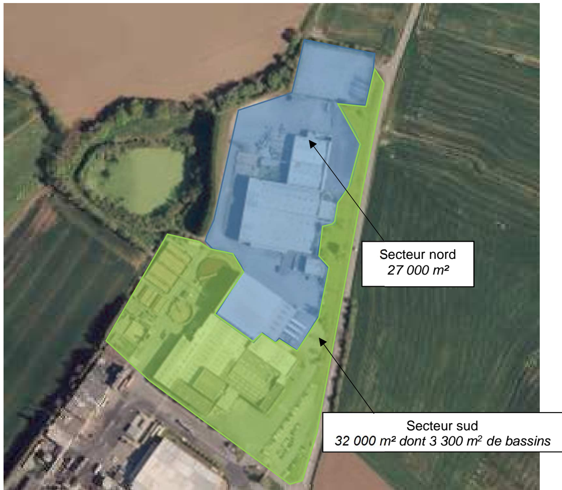
Figure 16. Localisation des principaux secteurs de drainage des eaux pluviales et des eaux d'extinction incendie
